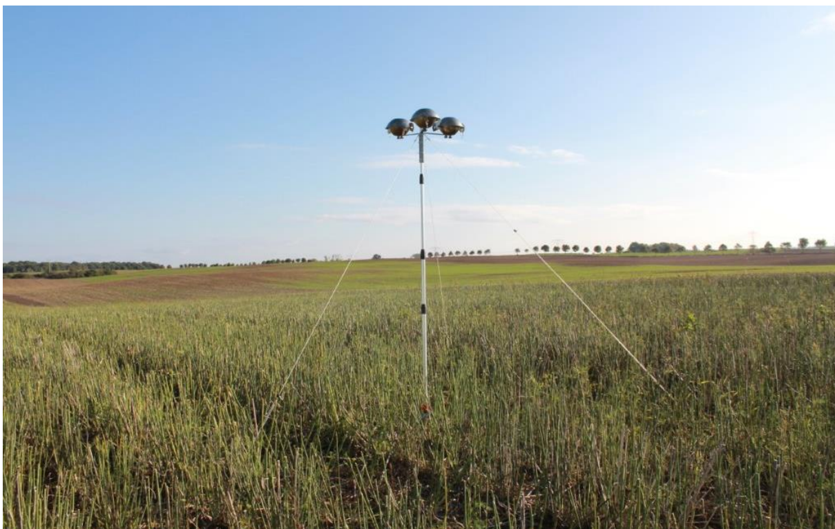
Abb. 20: Passivsammler-Einrichtung am Messpunkt P01, Körnerfenchel-Kultur bei Wilmersdorf
