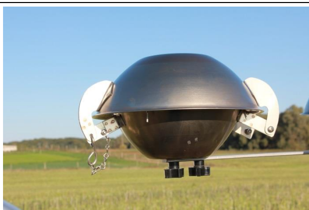
Abb. 15: Passivsammler des GAPS Networks für Außenluft der Firma Tisch Environmental
