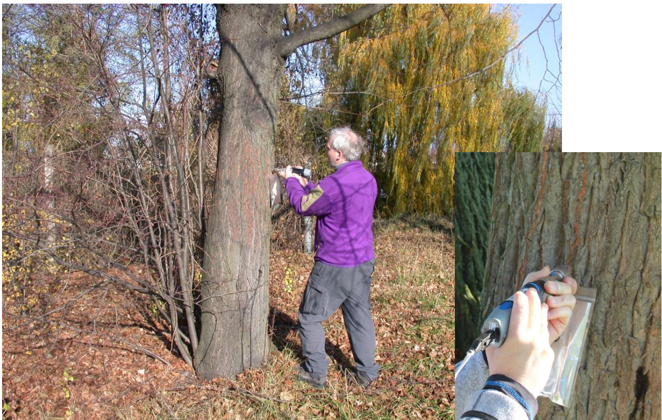
Abb. 13: Standardisierte Entnahme der äußeren Rinde zum Luftgüte-Rindenmonitoring mit dem Rindenprobenehmer (Archivbild Hofmann)
